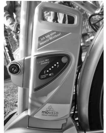
Abschließbarer Akku am Movelo-Elektrofahrrad
