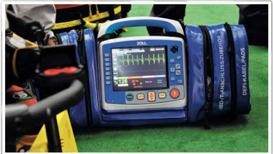
Der angeschlossene Patientenmonitor überträgt die aufgenommenen Vitaldaten drahtlos mit Hilfe des portablen AVA Routers oder des im Fahrzeug installierten Routers an den Notarzt.
