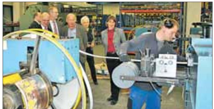
An der Stanz- und Profileranlage, in der Abt. Blechfertigung werden unterschiedliche Leuchtenprofile aus lackiertem Bandstahl in verschiedenen Breiten gefertigt. Der Einrichter, Herr Randolph Austen, bereitet die Anlage gerade vor, indem er das Bandmaterial in die Richtmaschine an der Anlage einfädelt.
