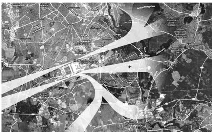
Schematische Darstellung der Abflugkorridore bei Betriebsrichtung Ost – Quelle FBB
