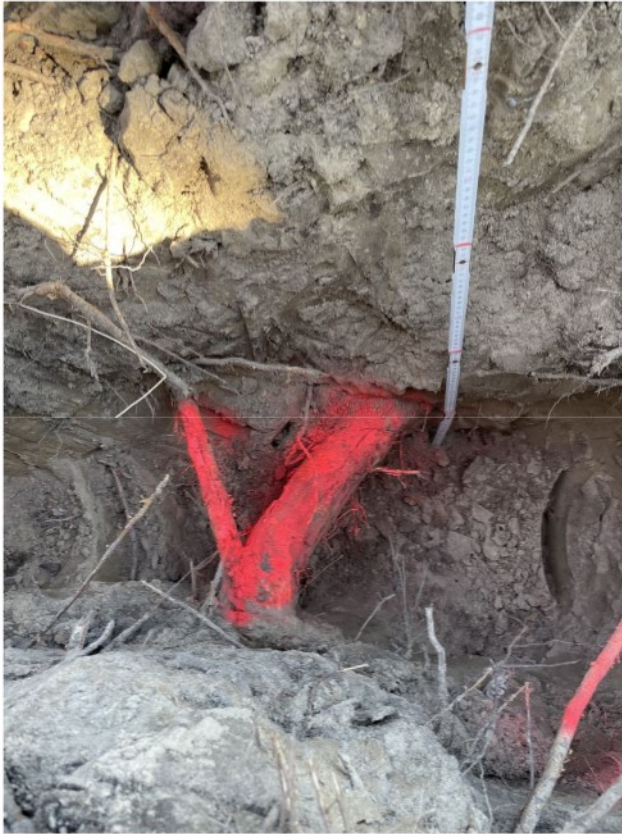
Bild 38: Suchgraben 9, mit einer 10cm starken Starkwurzel
