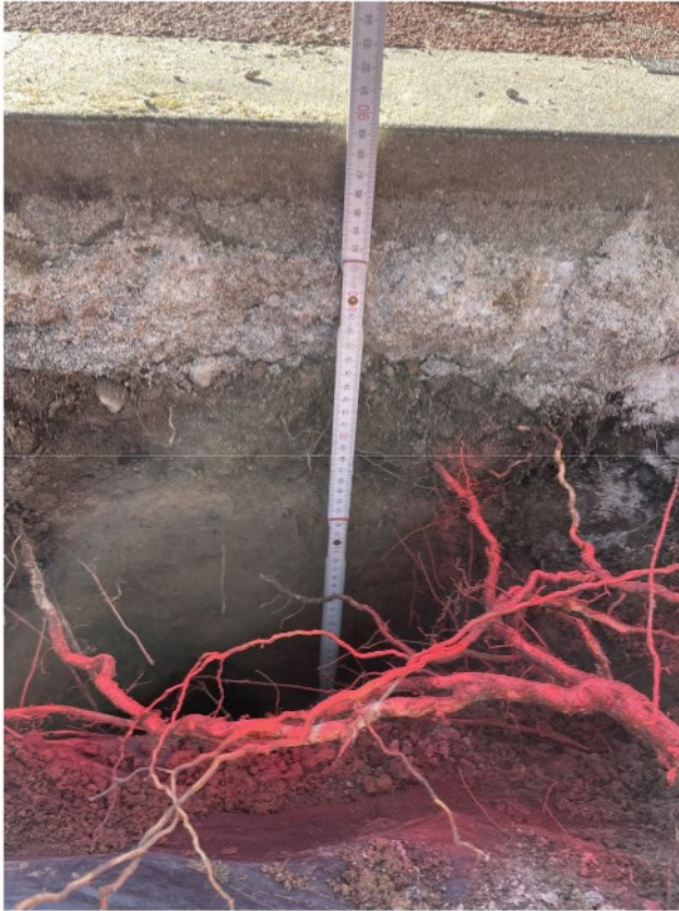
Bild 54: Suchgraben 15, mit einer 4cm starken Grobwurzel
