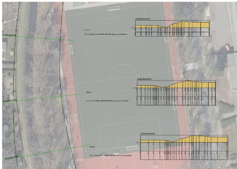
Abb. 005 Böschungssituation im Westteil der Anlage in Richtung Wasserlauf
