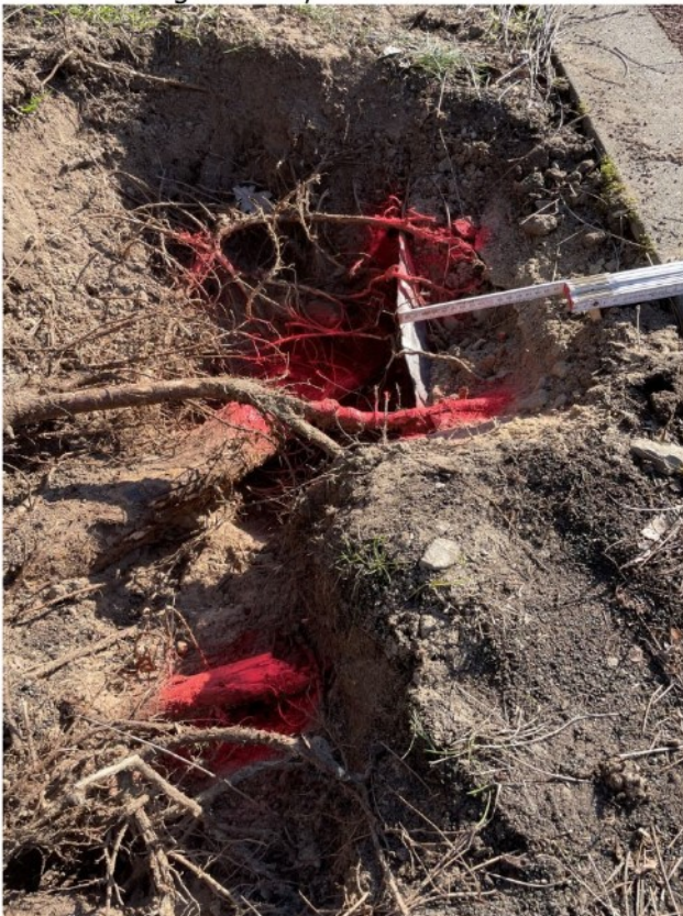
Bild 47: Suchgraben 13, mit einer 10cm und einer 5cm starken Grobwurzel sowie einer 2cm starken Grobwurzel
