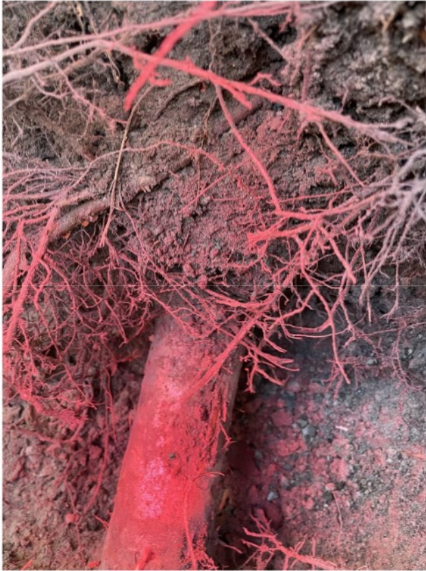
Bild 24: Suchgraben 3, vorgefundene 5cm starke Starkwurzel
