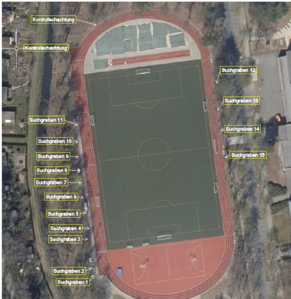
Bild 15: Luftbildaufnahme (Google Maps, Zugriff am 10.03.2022): Lage der Suchschachtungen
