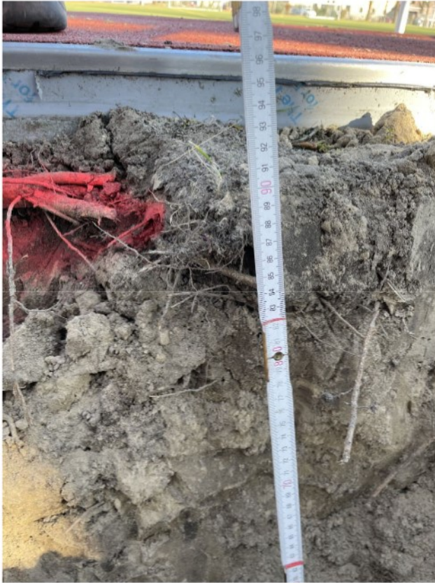
Bild 40: Suchgraben 10, mit oberflächennahen Grobwurzeln
