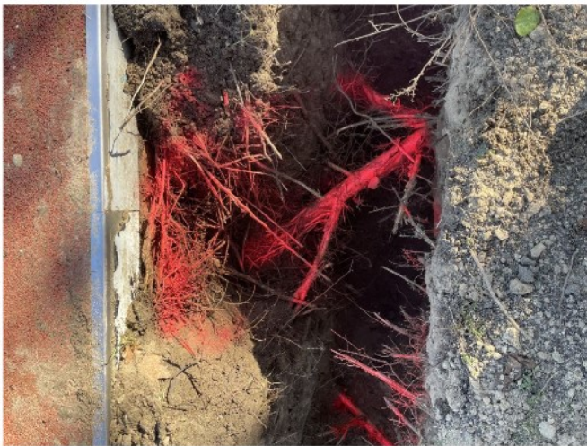
Bild 33: Suchgraben 7, mit einer 3cm starken Grobwurzel
