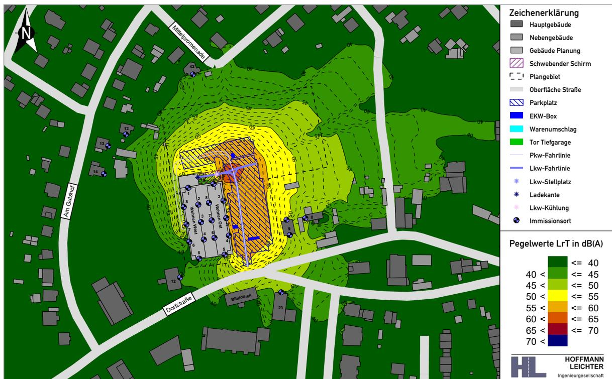
Abbildung 5-1 Isophonenkarte in 5 m Höhe über Gelände | Beurteilung nach TA Lärm | tags, 06:00 - 22:00 Uhr
