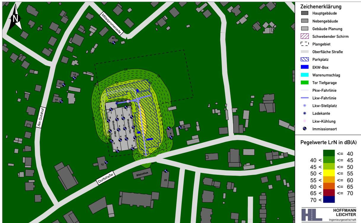
Abbildung 5-2 Isophonenkarte in 5 m Höhe über Gelände | Beurteilung nach TA Lärm | nachts, 22:00 - 06:00 Uhr
