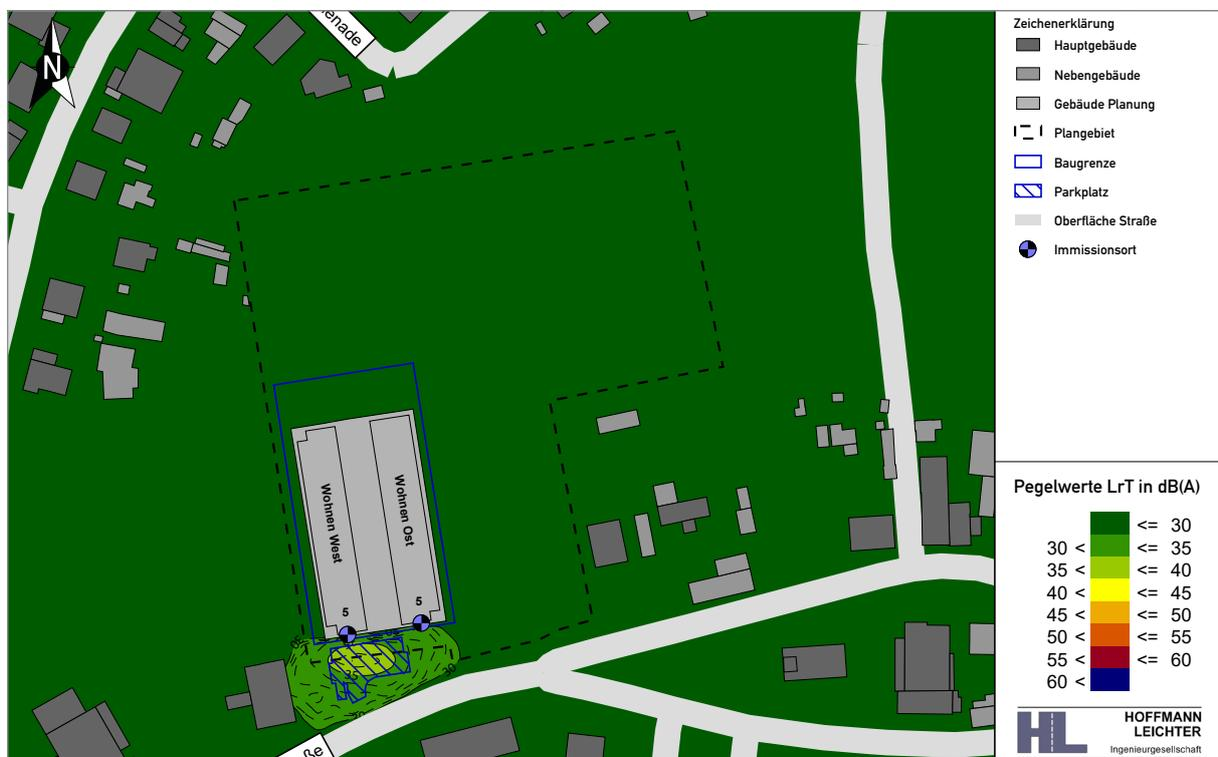
**Abbildung 5-3** Isophonenkarte in 5 m Höhe über Gelände | Freizeitlärm | Beurteilung nach TA Lärm | tags, 06:00 - 22:00 Uhr
