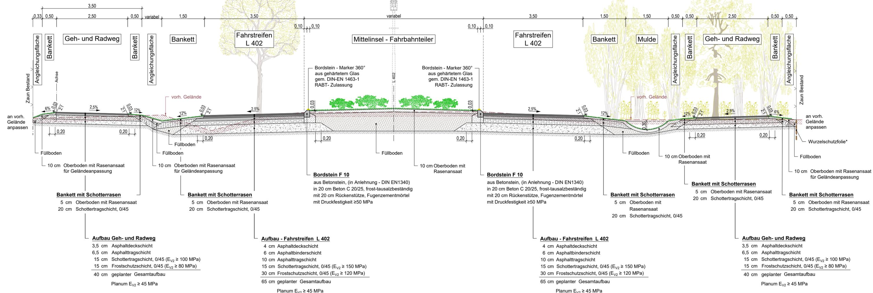
Bei Grundstückszufahrten / Zuwegungen erfolgt ein um 10 cm verstärkter Aufbau der Schottertragschicht.
